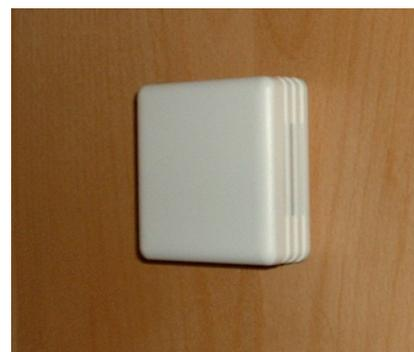
Der Temperatursensor 30118 mit 5 Meter Anschlusskabel ist für den Einsatz an der Ethernetbox (30301, 30302, 30303) oder an seriellen oder parallelen Adaptern des MessPC Systems vorgesehen. Durch den RJ-45 Stecker kann der Sensor mit üblichem Datenkabel auch über Datennetze gepatched werden.
