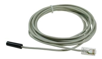
Der Temperatursensor 30107 mit 5 Meter Anschlusskabel ist für den Einsatz an der Ethernetbox (30301, 30302, 30303) oder an seriellen oder parallelen Adaptern des MessPC Systems vorgesehen. Durch den RJ-45 Stecker kann der Sensor mit üblichem Datenkabel auch über Datennetze gepatched werden.
