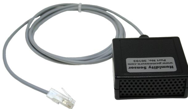
Der Feuchtesensor 30103 mit 1,5 Meter Anschlusskabel ist für den Einsatz an der Ethernetbox (30301, 30302, 30303) oder an seriellen oder parallelen Adaptern des MessPC Systems vorgesehen. Durch den RJ-45 Stecker kann der Sensor mit üblichem Datenkabel auch über Datennetze gepatched werden.
