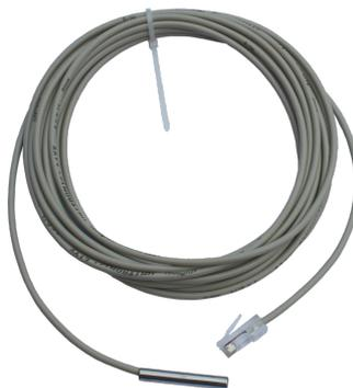
Der Temperatursensor 30102 mit 5 Meter Anschlusskabel ist für den Einsatz an der Ethernetbox (30301, 30302, 30303) oder an seriellen oder parallelen Adaptern des MessPC Systems vorgesehen. Durch den RJ-45 Stecker kann der Sensor mit üblichem Datenkabel auch über Datennetze gepatched werden.
